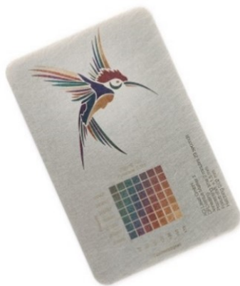
Abbildung 1: Beispiel für eine Markierung mit Anlassfarben auf Edelstahl [Quelle: ACI Laser GmbH]
